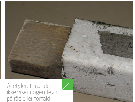
Ikke-acetyleret træ, der viser alvorlige tegn på råd og forfald
