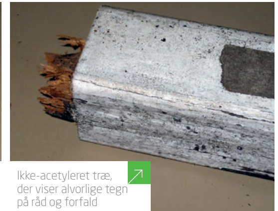
Ikke-acetyleret træ, der viser tegn på råd og forfald
