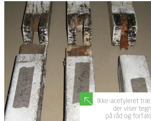
Ikke-acetyleret træ, der viser alvorlige tegn på råd og forfald
